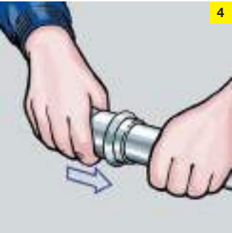
Наденьте на трубу пресс-фитинг до упора.
