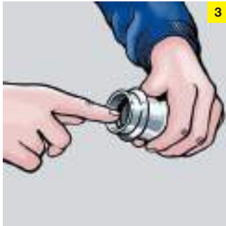
Проверьте посадку уплотнительного кольца.
