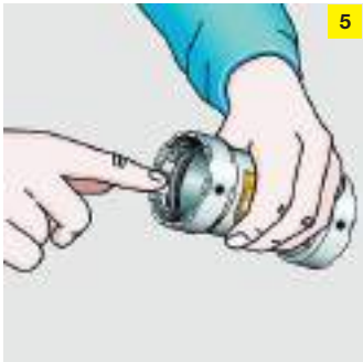
Проверьте правильность посадки колец (врезное кольцо очень острое, его нельзя касаться пальцами).
