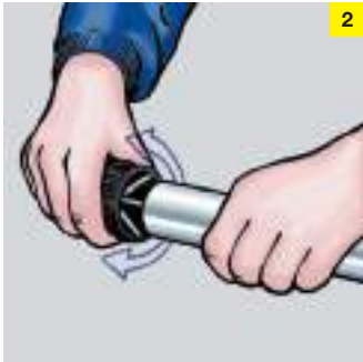
Снимите грат изнутри и снаружи трубы гратоснимателем.
