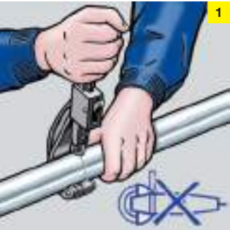
Аккуратно отрежьте трубу под прямым углом, не допуская деформации трубы.
