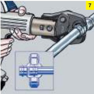
Откройте пресс-клещи и установите их под прямым углом на пресс-фитинг. Убедитесь, что клещи и фитинг правильно установлены. Начните опрессовку.
