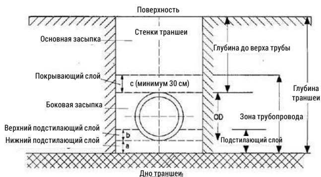
РИС. 3. УСТРОЙСТВО ТРАНШЕИ
