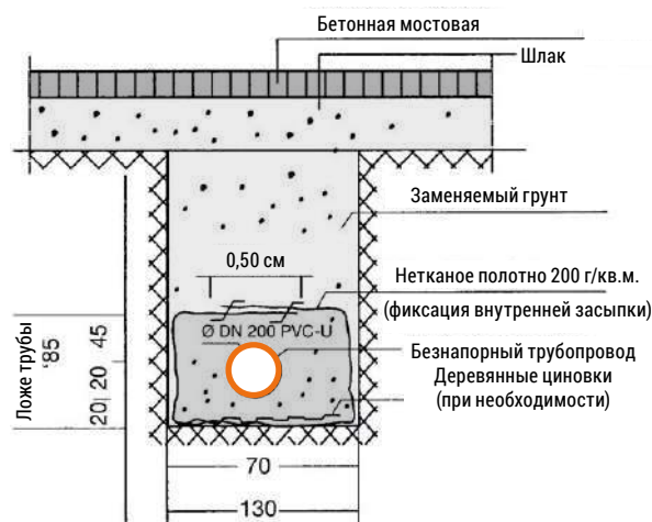
РИС. 7. ПРИМЕР ПРОКЛАДКИ ТРУБ В МЯГКОМ ГРУНТЕ
