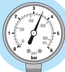
рис. 9. После того, как давление достигнет определенного (настроенного) значения (давление отключения), реле остановит насос.
