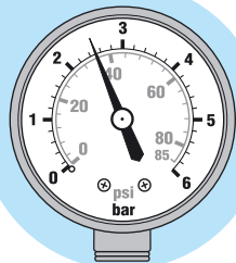
рис. 10. При начале водоразбора, вода, находящаяся в мембране гидроаккумулятора под давлением, начинает подаваться потребителю. При этом давление в системе начинает уменьшаться, а насос остаётся выключенным.
